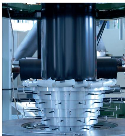
**Bild 2.** Bis zu 32% mehr Durchsatz bei der Blasfolienextrusion ermöglicht ein neuartiges adaptives Luftführungssystem (© IKV)
